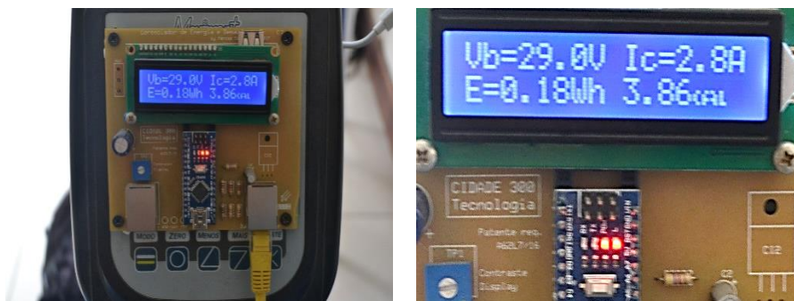
Figura 29 – SISTEMA DE MEDIÇÃO DESENVOLVIDO PARA A BICICLETA ERGOMÉTRICA, COM ARDUÍNO NANO
