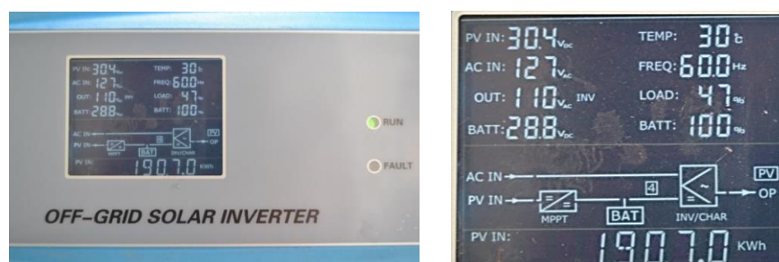
Figura 28 – PAINEL DO INVERSOR OFF-GRID, MEDIÇÕES PARA LEVANTAMENTO DE DADOS
