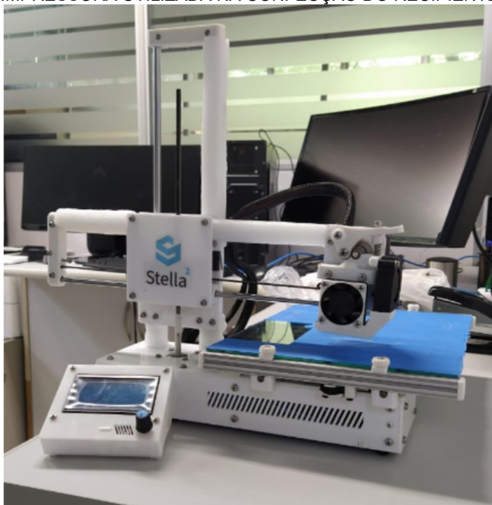
FIGURA 16 – IMPRESSORA UTILIZADA NA CONFEÇÃO DO RECIPIENTE DO SENSOR.
