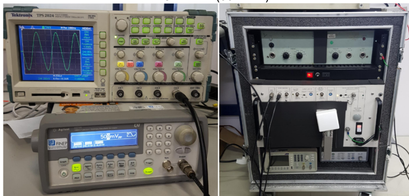
FIGURA 21 – EQUIPAMENTOS PARA ENVELHECIMENTO ELÉTRICO DO PRIMEIRO LOTE DE AMOSTRAS (30 DIAS).
