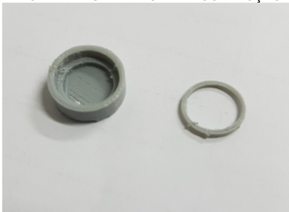
FIGURA 17 – RECIPIENTE UTILIZADO PARA CONFECCÃO DO SENSOR.
