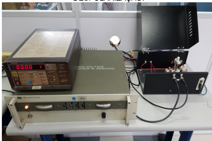
FIGURA 27 – FONTE DE TENSÃO E ELETRÔMETRO PARA ENSAIO DE POLARIZAÇÃO E DESPOLARIZAÇÃO.
