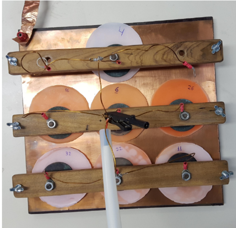
FIGURA 23 – SEGUNDO LOTE DE AMOSTRAS PARA ENVELHECIMENTO ELÉTRICO (30 DIAS).
