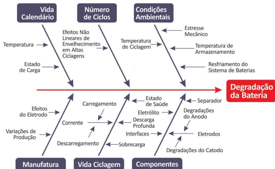
FIGURA 6– DIAGRAMA DE ISHIKAWA DOS FATORES DE ENVELHECIMENTO QUE LEVAM À DEGRADAÇÃO DA BATERIA DE ÍONS DE LÍTIO
