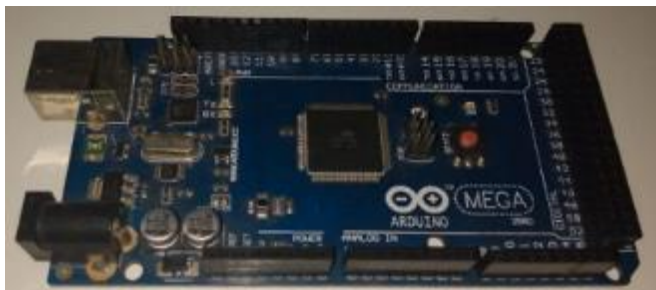
Figura 88 - Arduino ATmega para confecção do protótipo Fonte: O autor.
