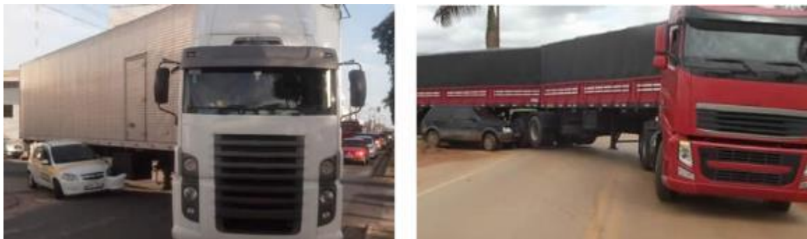
Figura 1 - Acidentes causados pela falta de visibilidade lateral em conversões Fonte: Truck Vision (2017)
