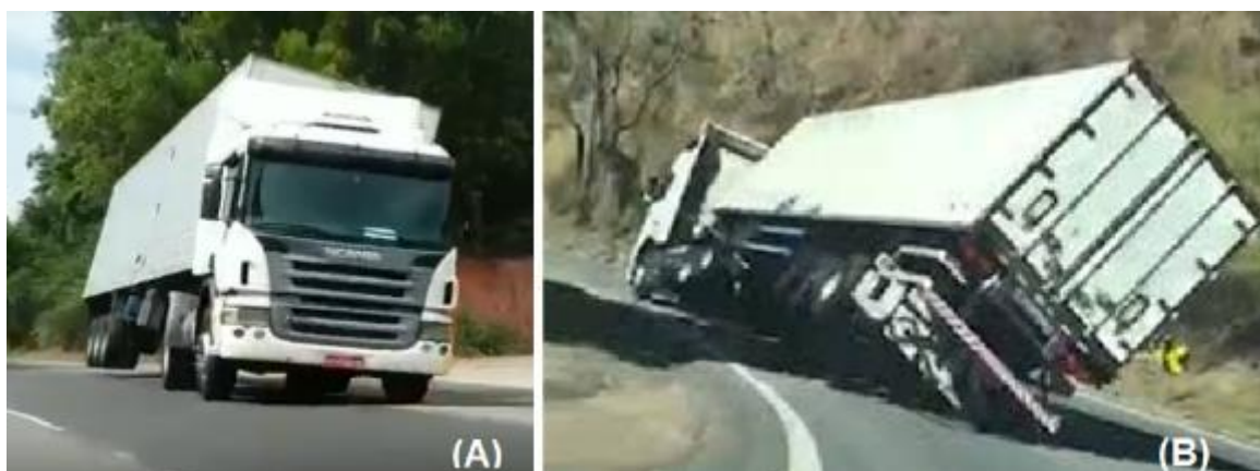
Figura 18 – Semirreboque rígido no limiar de tombamento(A) Em tombamento inevitável(B) Fonte: Adaptado de Truck Vision (2019)
