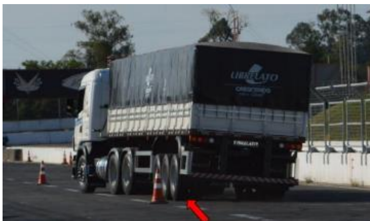
Figura 14 – Manobra de slalom a 40km/h de uma carreta graneleira carregada Fonte: Boaretto (2012)
