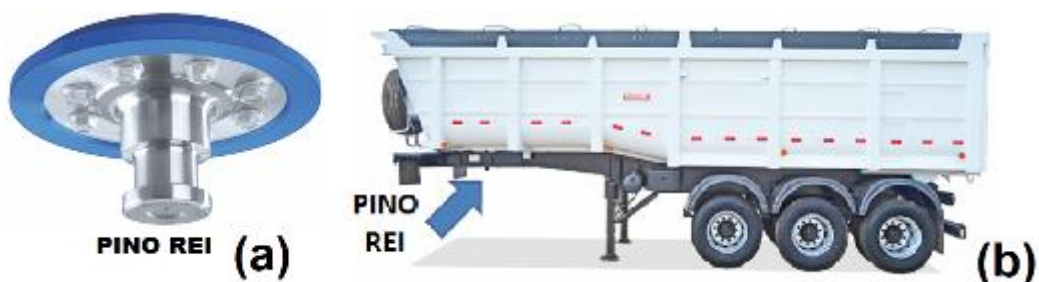
Figura 4 - Pino rei(a) e carreta tipo Semirreboque(b) Fonte: Adaptado de Jost (2018)
