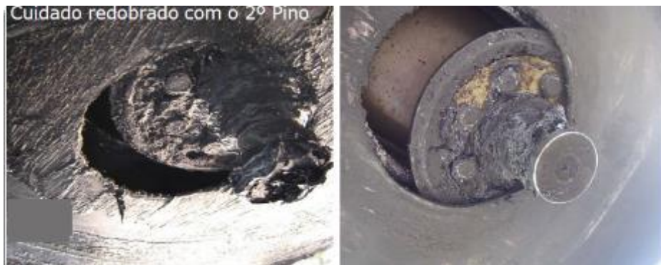
Figura 59 – (A) 2º Pino rei arrancado e (B) Desatrelamento do segundo semirreboque Fonte: Adaptado de Melo (2014)
