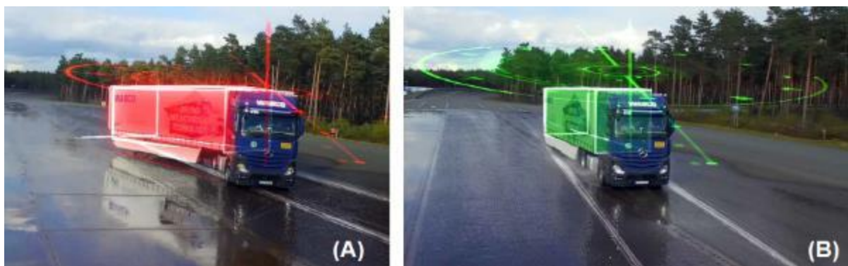
Figura 51 – (A) Veículo em Efeito Canivete sem ESC (B) Veículo estável com ESC Fonte: Adaptado de Wabco (2020)
