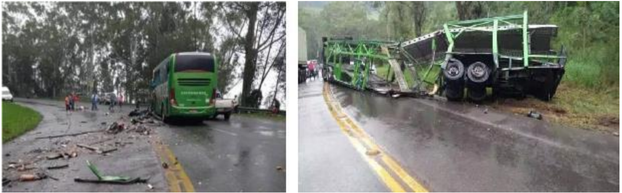
Figura 6 - Acidente entre uma carreta e um ônibus causado por efeito chicote Fonte: G1 (2019)
