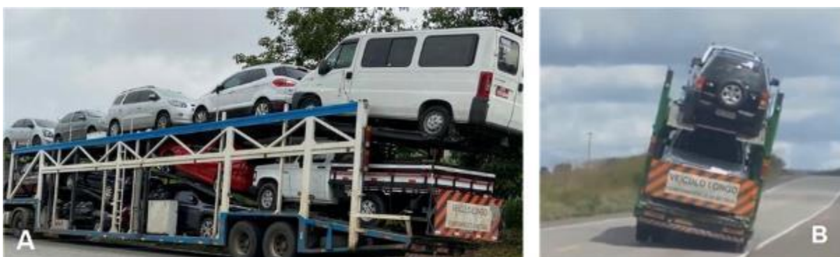
Figura 63 – Cegonheira com carga de veículos pesados na extremidade Fonte: Do Autor e G1 (2013)
