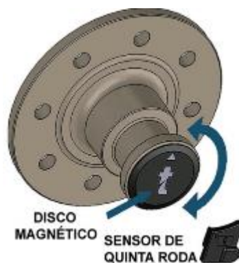
Figura 5 - Sensor de Quinta Roda e Disco Magnético de Pino Rei do Retrovisor Inteligente Fonte: Truck Vision (2017)
