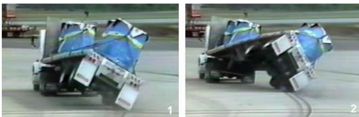
Figura 19 – Semirreboque não-rígido em condição de tombamento Fonte: Adaptado de Vicroads (2012)
