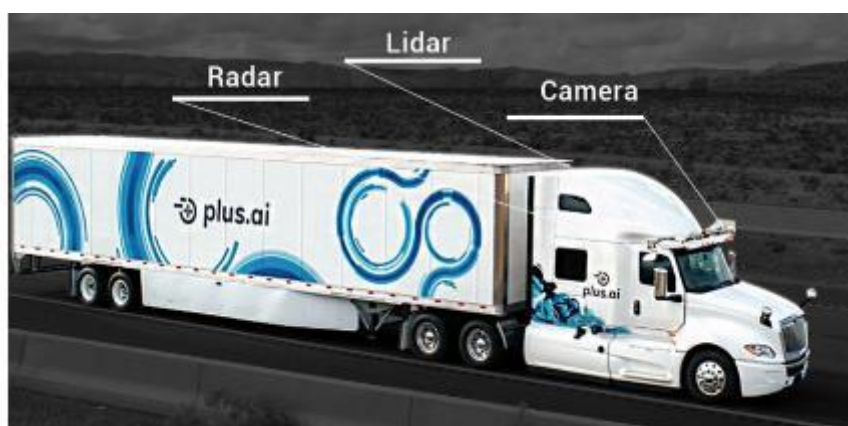
Figura 72 – Tecnologia embarcada em um caminhão articulado autônomo Fonte: Plus.AI (2020)
