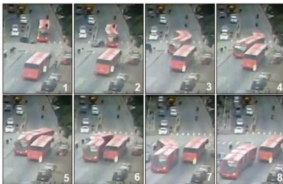
Figura 10 - Ônibus biarticulado “chicoteia” devido à Amplificação Traseira Fonte: Adaptado de Massa News (2016)
