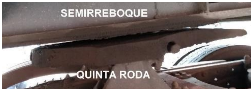
Figura 111 – Engate Alto semirreboque sem encostar na quinta roda após engate
