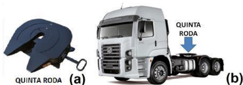
Figura 3 - Quinta Roda(a) e Caminhão tipo Cavalo Mecânico(b). Fonte: Adaptado de Sudoeste Caminhões (2019)
