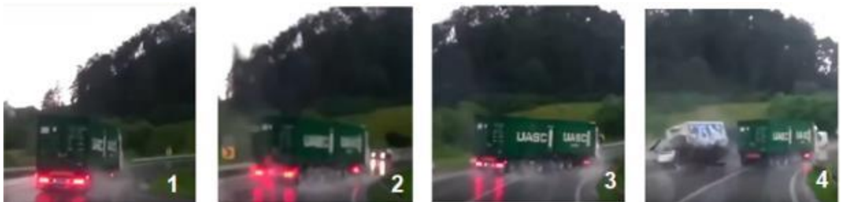
Figura 38 – Acidente por escorregamento lateral do semirreboque em pista escorregadia Fonte: Adaptado de Truck Vision (2019)
