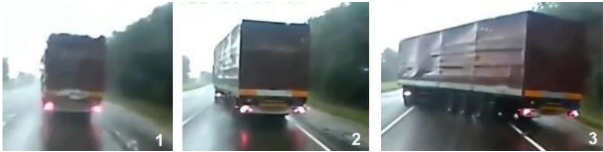
Figura 33 – Veículo em Efeito Chicote Unilateral em baixa velocidade Fonte: Adaptado de Truck Vision (2019)
