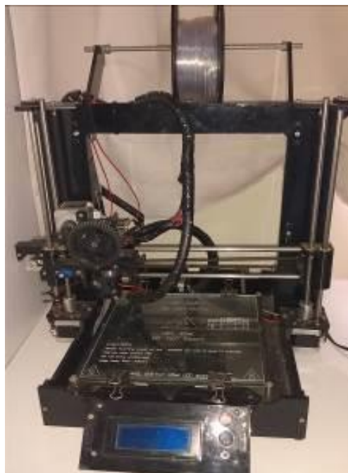
Figura 92 - Impressora 3D para confecção das peças protótipo Fonte: O autor.
