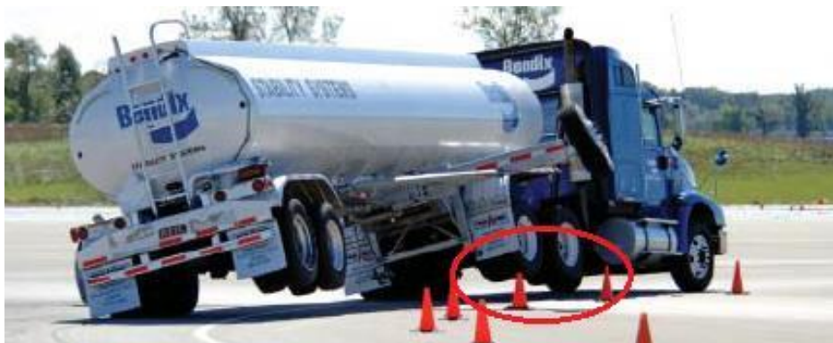
Figura 29 – Veículo em tombamento inevitável – Etapa 3 Fonte: Bendix (2015)
