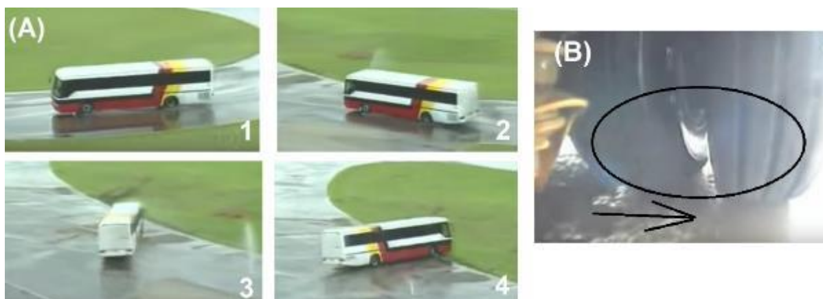
Figura 67 – (A) Instabilidade em guinada do ônibus (B) Pneu deformado durante conversão Fonte: Adaptado de Autoesporte (2004)
