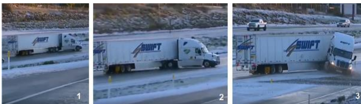
Figura 32 – Veículo em Efeito Canivete em baixa velocidade Fonte: Adaptado Truck Vision (2019)
