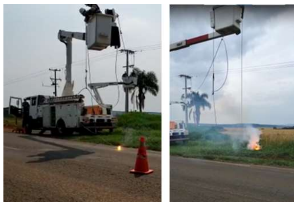
FIGURA 50 – ENSAIOS DE FAI LADO FONTE NO PONTO FAI3
