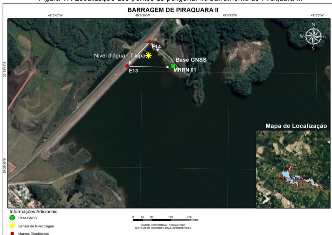
Figura 17: Localização dos pontos da poligonal no barramento de Piraquara II.
