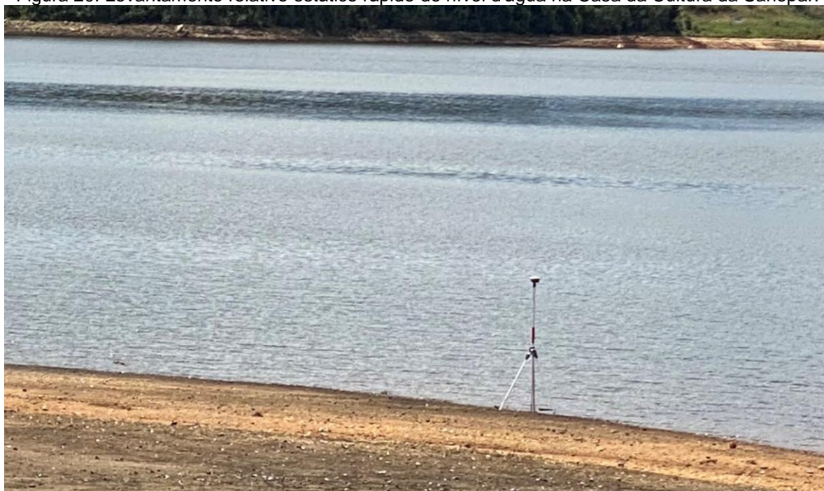
Figura 20: Levantamento relativo estático rápido do nível d'água na Casa da Cultura da Sanepar.
