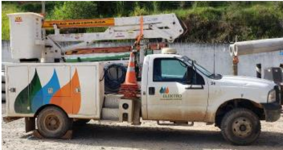
FIGURA 9 – LAYOUT GERAL DO CONJUNTO CAMINHÃO À DIESEL, CESTA AÉREA E CARROCERIA ATUALMENTE ATUALIZADO
