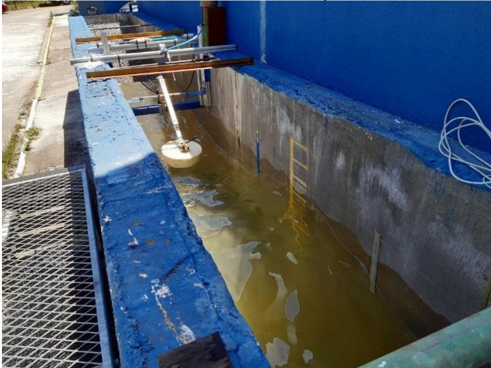
FIGURA 47 – ONDA GERADA PARA TESTES DE VALIDAÇÃO DO MODELO HIDRÁULICO
