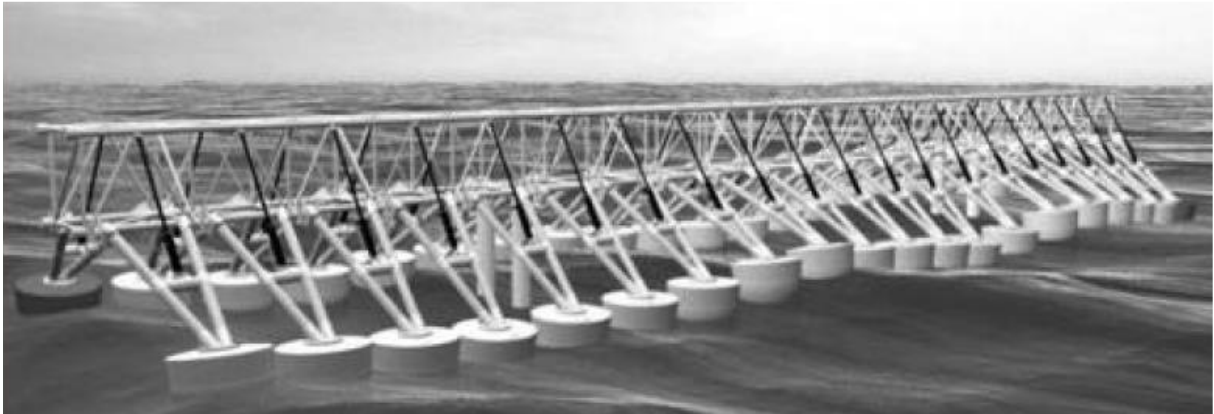
FIGURA 21 - WAVE STAR, UM SISTEMA ABSORVEDOR DE MÚLTIPLOS PONTOS
