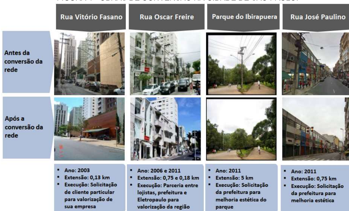
FIGURA 4 - OBRAS DE CONVERSÃO NA CIDADE DE SÃO PAULO.
