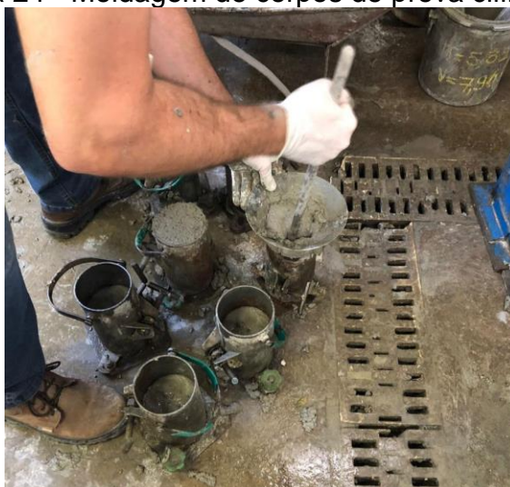
Figura 24 - Moldagem de corpos de prova cilíndricos
