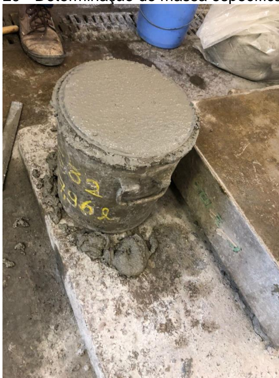
Figura 29 - Determinação de massa específica fresca
