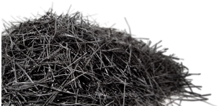
Figura 5 - Fibras de polipropileno em monofilamentos para utilização em matrizes cimentícias
