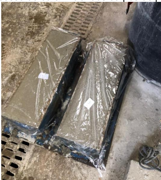
Figura 28 - Processo de cura inicial dos corpos de prova prismáticos
