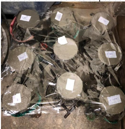
Figura 27 - Processo de cura inicial dos corpos de prova cilíndricos
