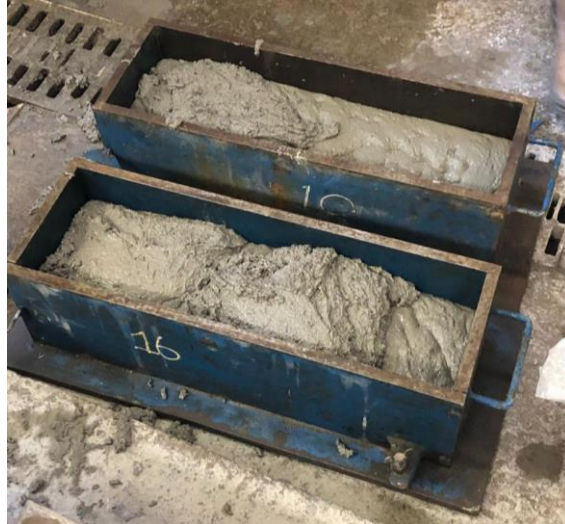
Figura 25 - Moldagem de corpos de prova prismáticos
