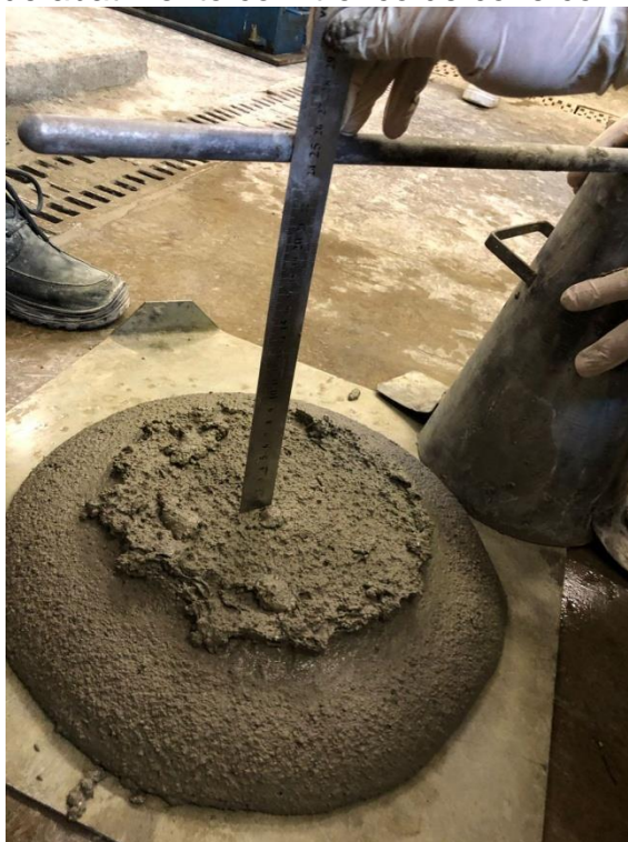
Figura 23 – Teste de abatimento com tronco de cone com concreto sem fibra
