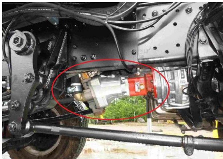
FIGURA 18 – IMAGEM DE UMA PTO MONTADA
