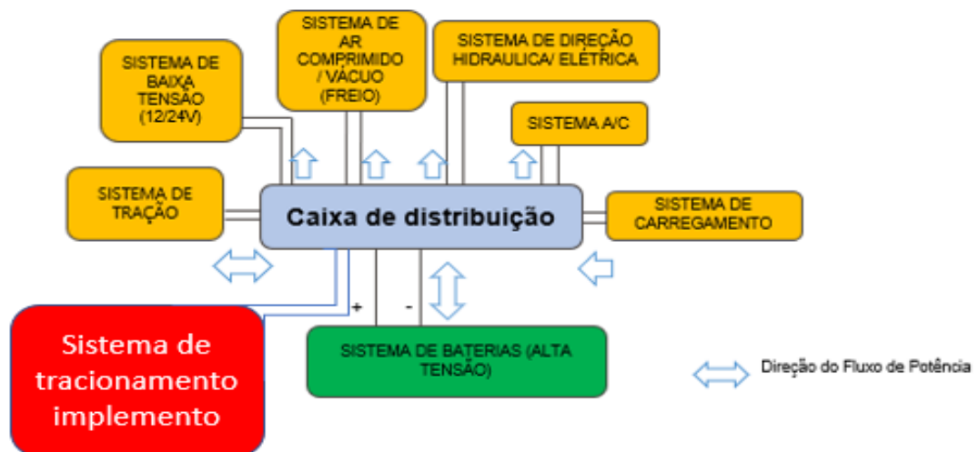
FIGURA 23 –ARQUITETURA ELÉTRICA CAMINHÃO VEB COM SISTEMA DE AUXILIAR DO IMPLEMENTO INTEGRADO
