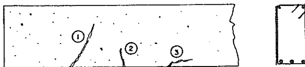
Porção de viga fletida.
